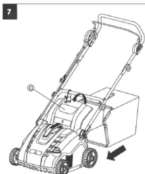
**NOTA:** La macchina può essere utilizzata senza il collettore, mantenendo il coperchio di protezione (10) abbassato.
